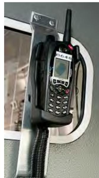
Photo d'un TPH 700 et son berceau-support (« Cradle ») dans un VSAV
