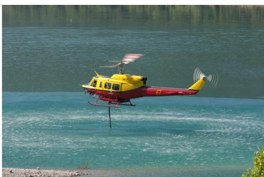
Biturbine d'une puissance maximale au décollage de 1800 chevaux, d'un poids à vide avec équipement de bombardement d'eau de 3170 kg, cet appareil vole à une vitesse de croisière de 186 km/h.
