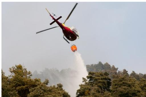
Dans sa version de largage, il emporte une charge de 1000 litres environ, largable en une seule soute. Le temps de remplissage de son réservoir ventral en vol stationnaire est de 45s.
