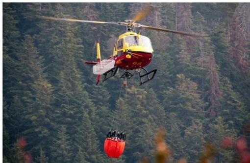
Monoturbine d'une puissance maximale au décollage de 900 chevaux, d'un poids à vide avec équipement de bombardement d'eau de 1350 kg, cet appareil vole à une vitesse de croisière de 230 km/h.
