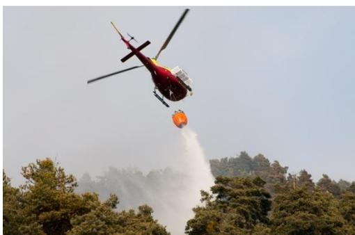
Dans sa version de largage, il emporte une charge de 1000 litres environ, largable en une seule soute. Le temps de remplissage de son réservoir ventral en vol stationnaire est de 45 secondes.
