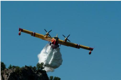
Avion amphibie dont la capacité d'emport est en moyenne de 5 800 litres. Il vole à une vitesse maximale de 377 km/h.
