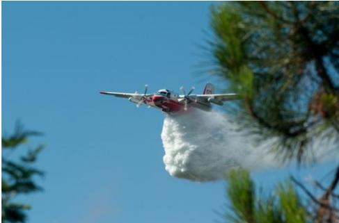
Le tracker dispose d'une capacité d'emport moyenne de 3 300 litres d'eau (ou de retardant). Il vole à une vitesse de croisière de 300 km/h.
