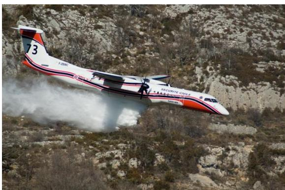
Avion de ligne à l'origine, ce bi turbo propulseur canadien a été transformé en avion bombardier d'eau.
